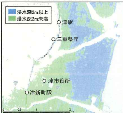
津波浸水想定(理論上最大クラス) 【津市 津駅～津新町駅付近】
