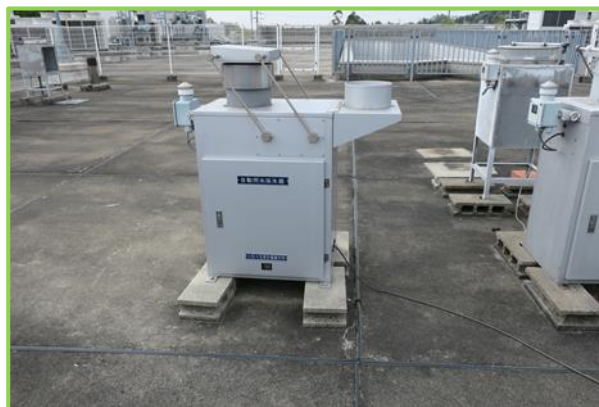
図2 自動雨水採水器(降水時開放型)
