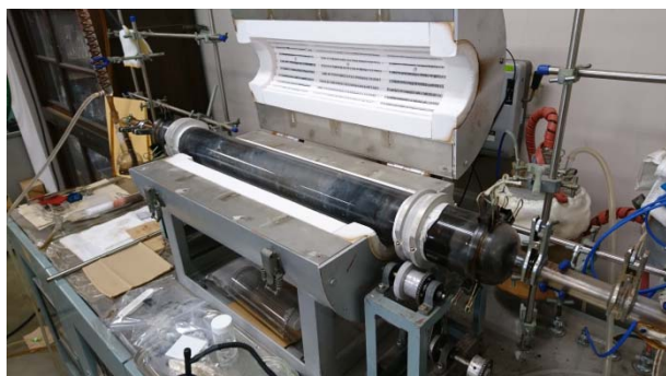
図 1 炭化焼成に用いた管状炉
