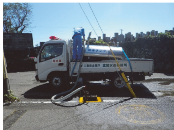
【給水車への補給作業(紀宝町)】
