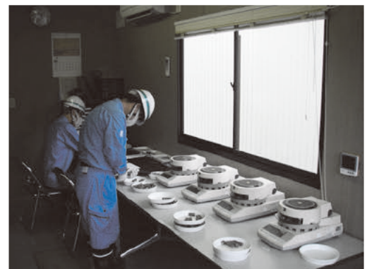
RDF受入検査
