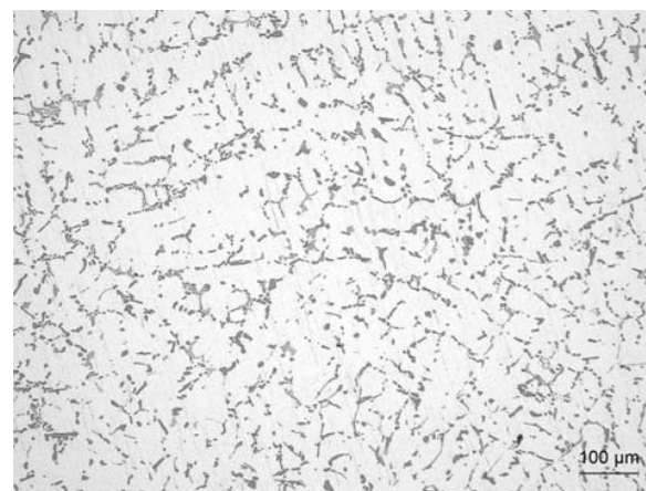
図2 AC2Bの顕微鏡組織 (溶体化処理後)
