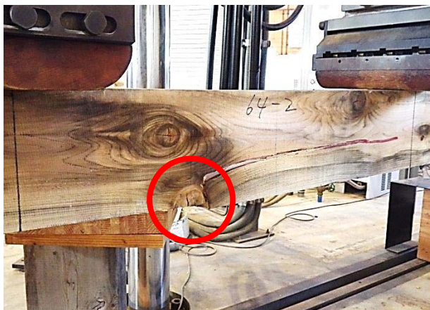
荷重点間の下側の大節より破壊した例
