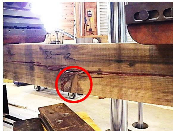
髄から延びる流れ節の箇所から破壊した例
