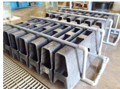
図 2. 小割生簀に沈めて使うアワビ専用シェルター
