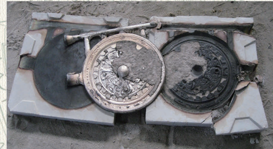
鋳型から出した銅鏡(模造品)
