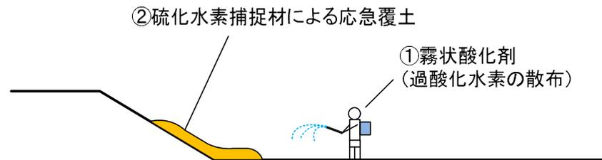
図 硫化水素ガス対策(応急対策)
