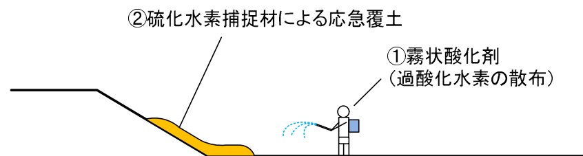
図 硫化水素ガス対策(応急対策)
