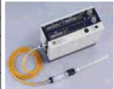
ガス警報器 (マルチ測定)
