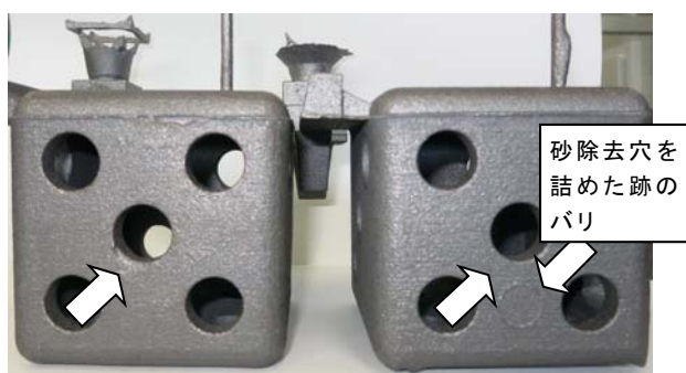
図 9 中子一体型鑄物の身食い (左が砂除去対策前、右が対策型)
