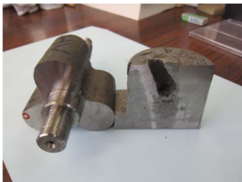
図 9 大きな押湯により引け巣を防止
