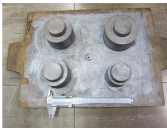
図 1 鑄物モジュラスの異なる引け試験片のマッチプレート
