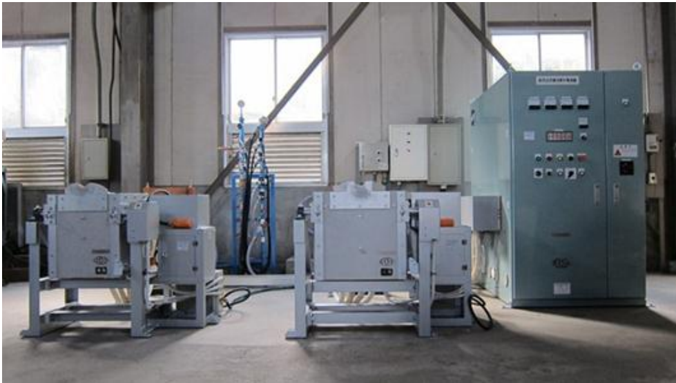
高周波誘導溶解炉全体図
