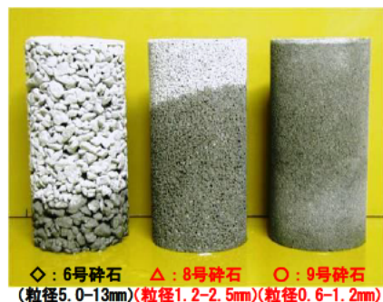
図1 小粒径ポーラスコンクリート供試体の一例
