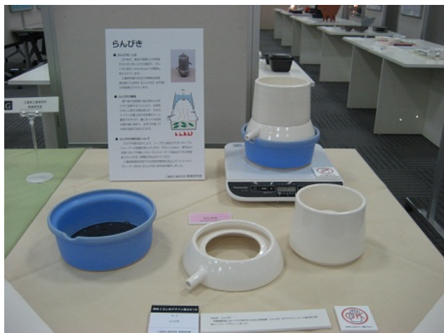
図2 フローラルウォーター抽出用陶製蒸留器「らんびき」
