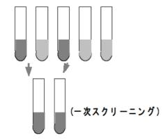
⑥ 28℃で3日間培養したのちTOCを測定する。 TOCで80%以上分解したものを優良 微生物群として、さらに分解試験を行う。
