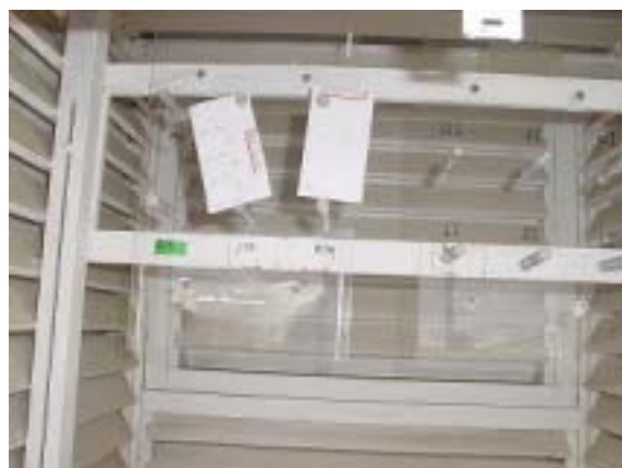
写真2 N式パッシブサンプラーの設置状況
