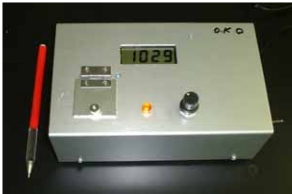
写真2 簡易UV計の外観
