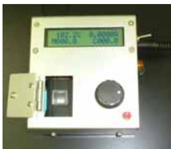
写真3 2電源(交流・バッテリー)式簡易UV計の外観
