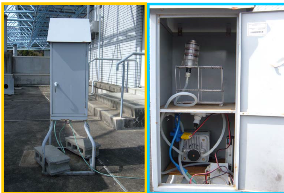
図4 PCI サンプラー（簡易法サンプラー）によるサンプリング
