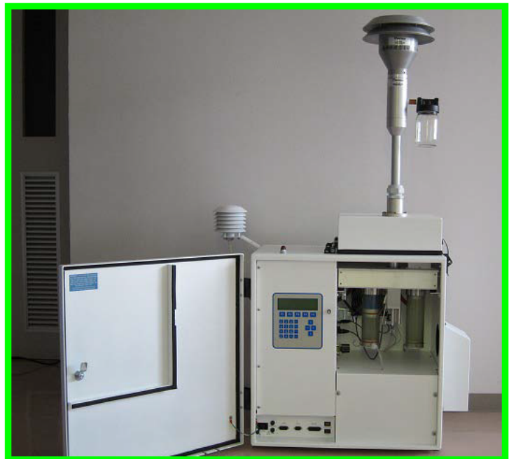
図3 FRM-2025 (標準法サンプラー) (自動連続サンプルング式)
