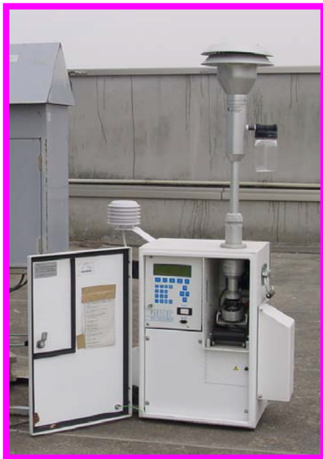
図2 FRM-2000 (標準法サンプラー) (単回サンプルング式)
