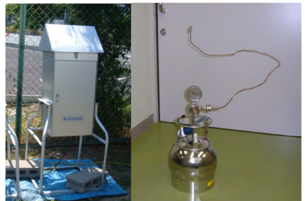
図 1 大気採取機器 (ハイボリュームエアサンプラー(左)、キャニスター(右))
