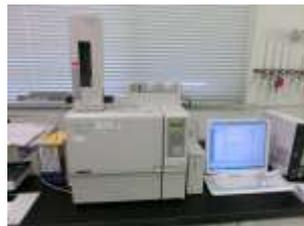
GC-FPD（有機リン系農薬検査に使用します）
