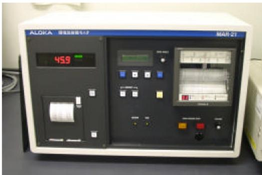
写真-1 モニタリングポスト測定部
