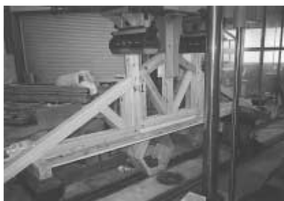
写真-3 小屋組強度性能試験状況
