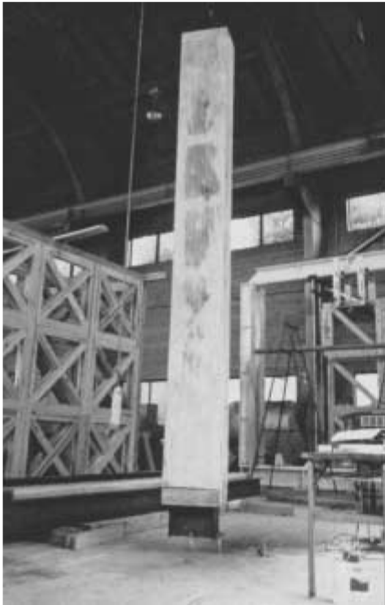
写真-3 複合構造材試験体
