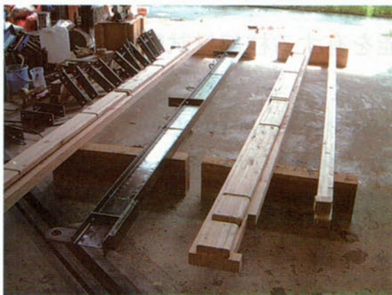
プライマー塗布した鋼材と接着用集成材
