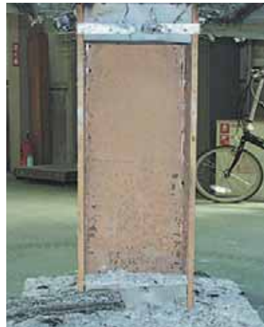
写真-8. 試験前と試験後 (No. 2, 2時間加熱)
