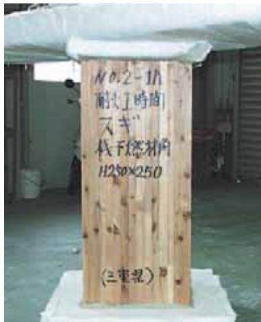
写真-2. 試験前と試験後 (No. 2, 1時間加熱)
