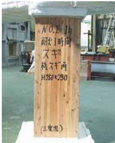
写真-1. 試験前と試験後 (No. 1, 1時間加熱)
