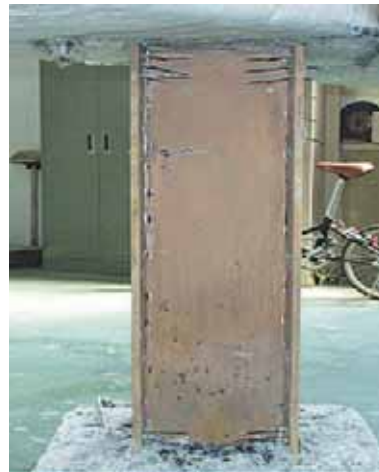
写真-7. 試験前と試験後 (No. 1, 2時間加熱)
