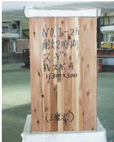
写真-7. 試験前と試験後 (No. 1, 2時間加熱)
