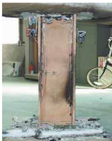
写真-4. 試験前と試験後 (No. 4, 1時間加熱)
