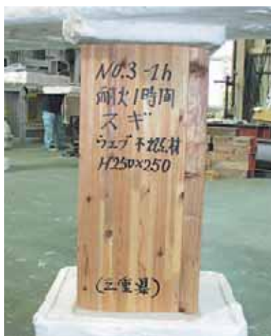
写真-3. 試験前と試験後 (No. 3, 1時間加熱)
