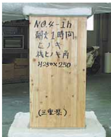
写真-4. 試験前と試験後 (No. 4, 1時間加熱)
