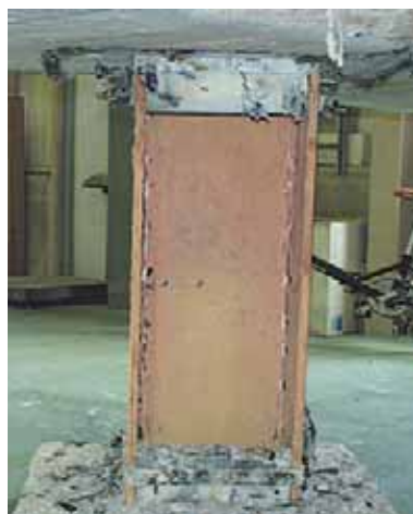
写真-11. 試験前と試験後 (No. 5, 2時間加熱)
