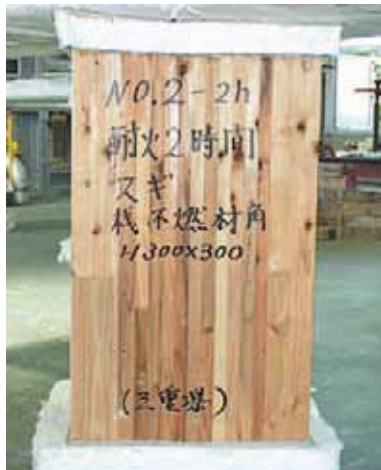
写真-8. 試験前と試験後 (No. 2, 2時間加熱)
