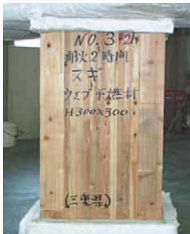
写真-9. 試験前と試験後 (No. 3, 2時間加熱)
