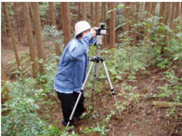
光量を測定したい位置に魚眼レンズがくるように、三脚で固定します。
