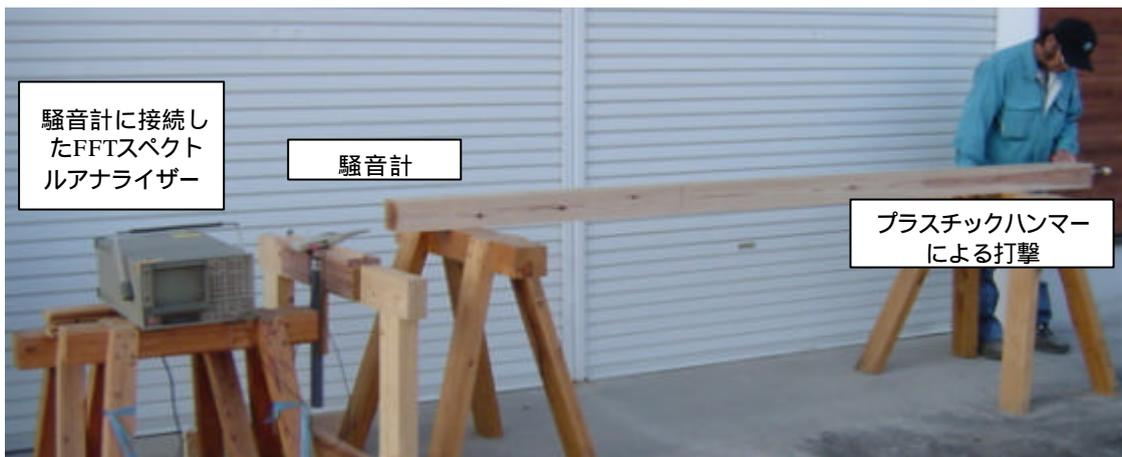
柱材と測定機器を写真のように配置します
