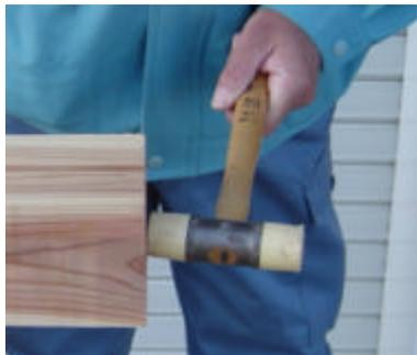
片方の木口をプラスチックハンマーで打撃します。
