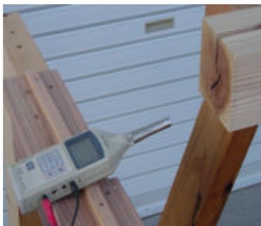
反対側の木口に騒音計を設置し、打撃音を収集します。
