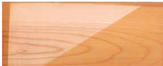
図. 紫外線等により一部が変色したヒノキ
