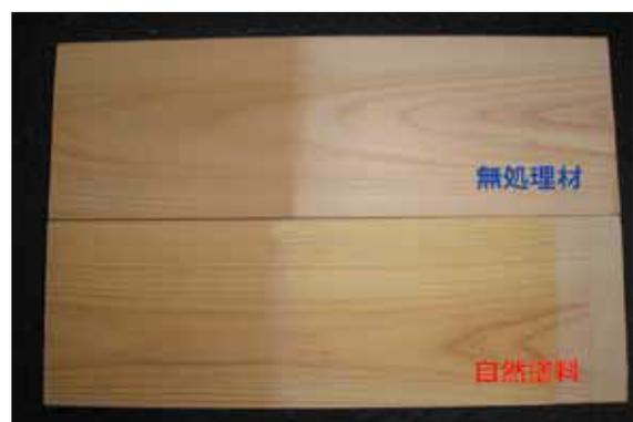
写真-2. 太陽光による材色の変化
