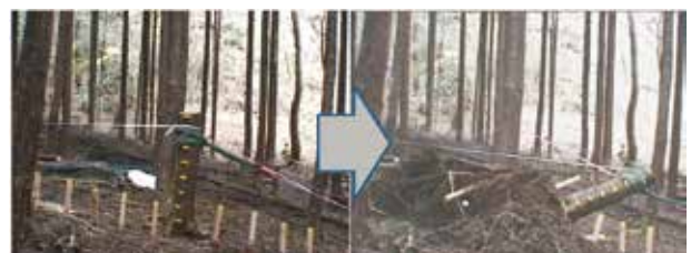
写真-2. 樹木引き倒し試験による根系抵抗力の測定
