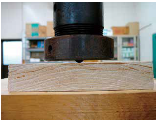
写真-1. JISによる木材の表面硬さ試験
