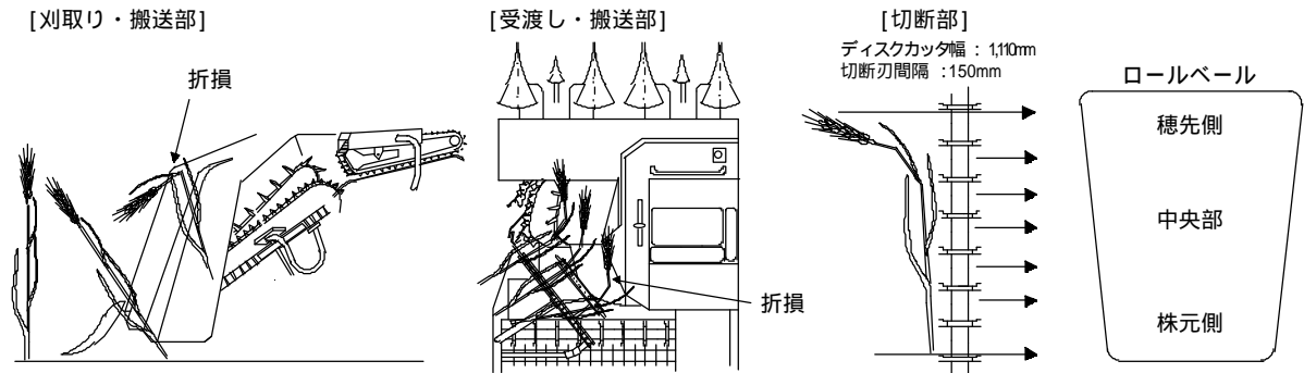
図1．飼料イネ用ロールベールによる長稈草種の収穫時の主な折損箇所と変形ロールの形状
