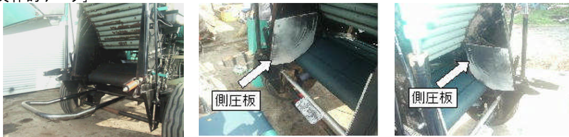
改良前（原型機） 改良後（成形室左右に側圧板を装着）
