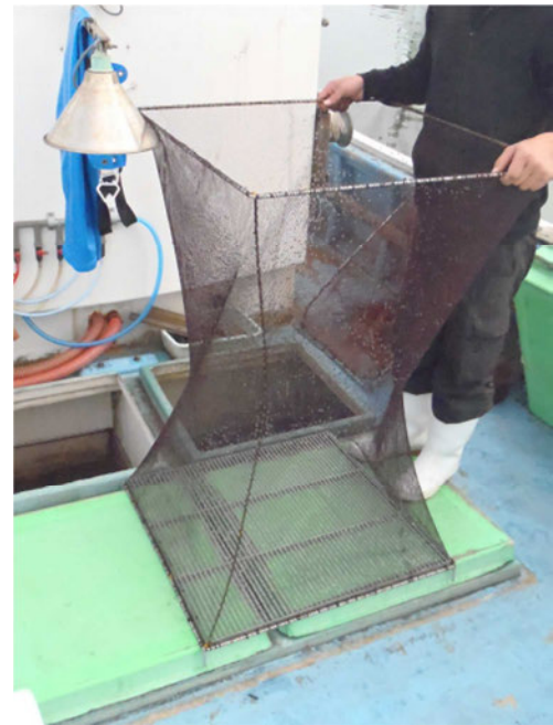
図1. 試作アナゴ選別器（魚槽内に垂下してアナゴを投入する）
