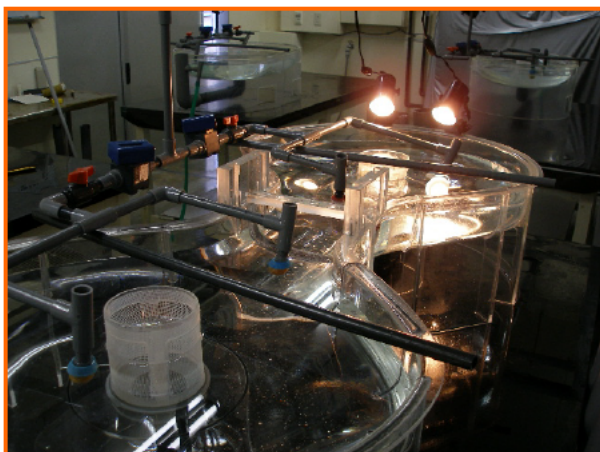
写真4 イセエビ幼生を飼育するために開発した装置 光を用いて幼生の行動をコントロールすることが特徴です（平成18年度特許出願）
