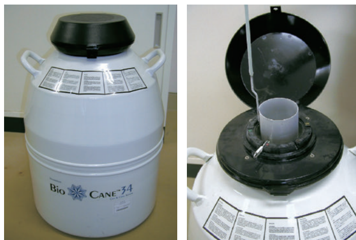
写真2 凍結保存のための液体窒素を収容する専用の容器 現在この中にアコヤ貝の精子を保存中。
