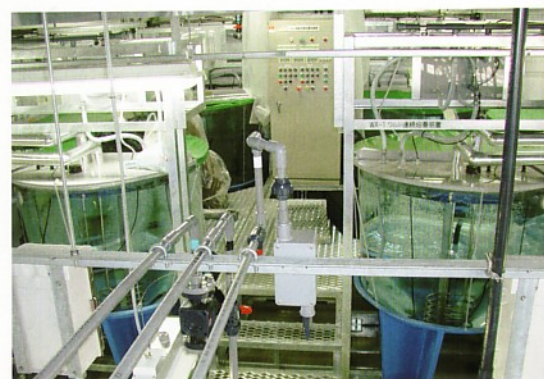
写真4 ワムシ連続培養装置
