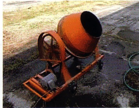
写真1 傾胴型ミキサー
