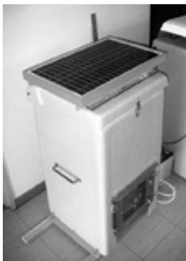
自発摂餌給餌機（KXB-40改） 自発摂餌スイッチ 図1. 自発摂餌給餌機と自発摂餌スイッチ
