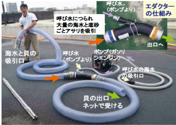
写真2. アサリ稚貝のポンプ吸引装置（水工研試作）
