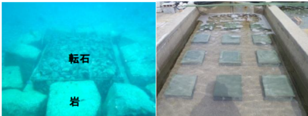
図6. アワビ礁 (左) と様々な隙間の幅をもつブロックを配置した実験水槽 (右)
