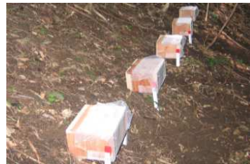
土砂受箱を設置し、土砂流出量を継続調査
