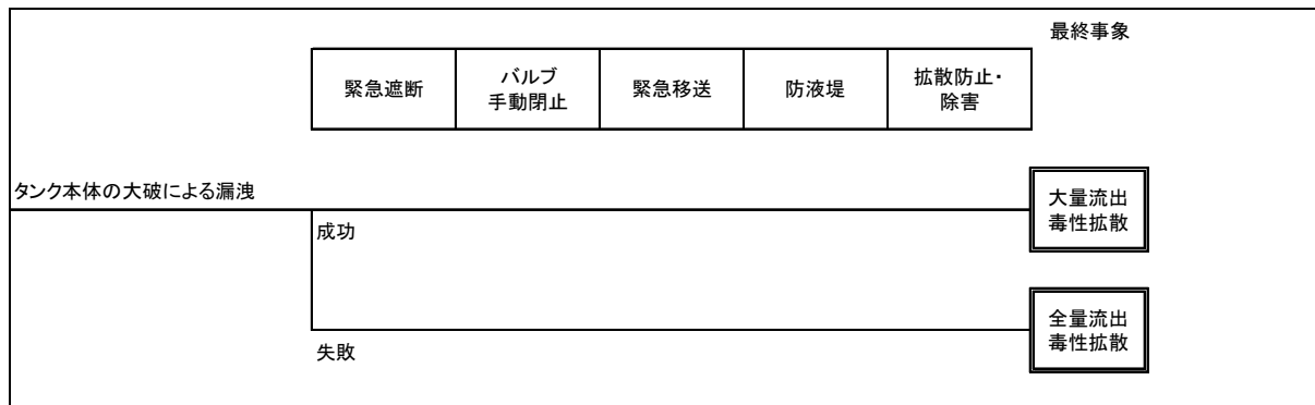
図 3-4 高圧ガス貯槽（毒性ガス）の災害拡大イベントツリー （タンク本体の大破による漏洩）
