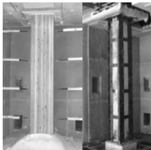
写真 1. 耐火 2 時間柱の試験前と試験後
