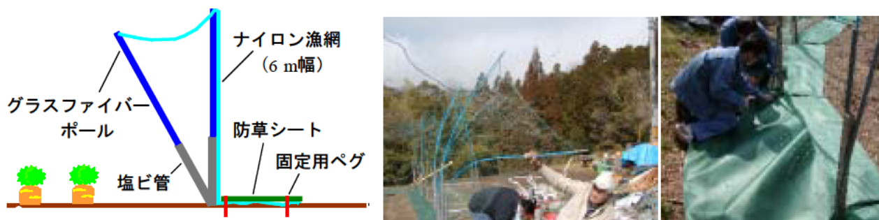
図-1. 現地適応試験に供試した簡易猿害防止柵
