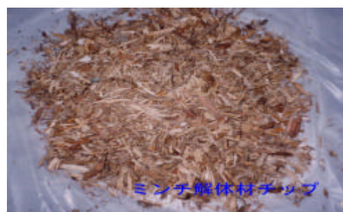
写真 - 2 ミンチ解体材チップ
