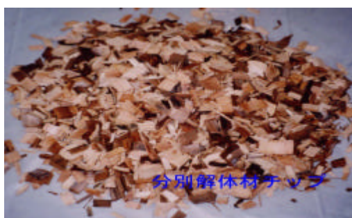
写真 - 1 分別解体材チップ
