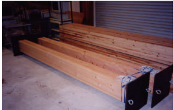
写真 - 4 柱試験体
