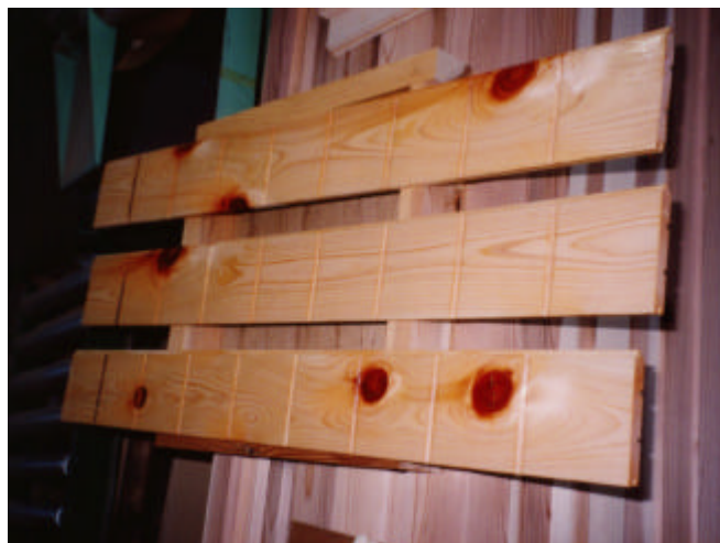
写真 - 4 フローリングに溝加工をした状態
