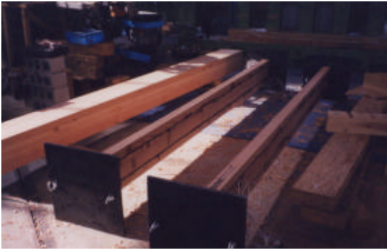
写真 - 3 柱試験体製作状況
