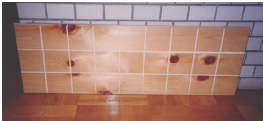
写真 - 3 シリコン樹脂で目地加工した状態
