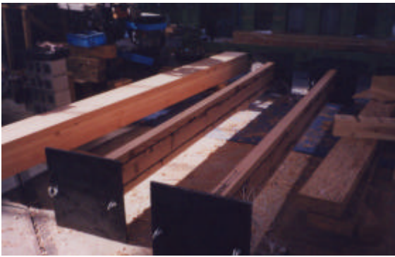
写真 - 3 柱試験体製作状況
