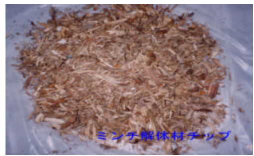
写真 - 2 ミンチ解体材チップ
